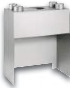
Sur certains de nos appareils, des carénages permettent de capturer au plus près l'air chaud autour du foyer. Des gaines de Ø 125 mm placées sur le carénage vont ensuite répartir l'air chaud vers d'autres pièces de l'habitation. Nos carénages sont constitués d'un ensemble de pièces en tôle électro-zinguée, assemblées par vis. Ils sont équipés de 4 sorties d'air chaud de Ø 125 mm.
